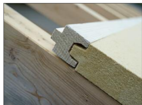
Das DELTA-SAFIX PROFIL ist kompatibel mit allen gängigen HF-Platten mit 60 mm Dicke und Deckbreiten zwischen 57,5 und 59,1 cm.
